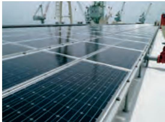
太陽光発電システムでは、甲板上（ガレージトップ）の約 1,000 平方m のスペースに、768 枚の HIT 太陽光パネルを搭載し、世界最大規模となる約 160kW の容量を確保。「船舶としては、桁の違う規模になる」（商船三井 技術部設計グループ 清水洋一グループマネージャー談）現在竣工していますが、省エネ船の建造促進につなげます。
